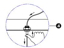
**Note:** Press the wire restraint to adjust the desired length of cable. **Remarque:** Appuyez sur le dispositif de retenue du fil pour régler la longueur du câble **Nota:** Presiona el freno del cable para ajustar la longitud que se desea del mismo
